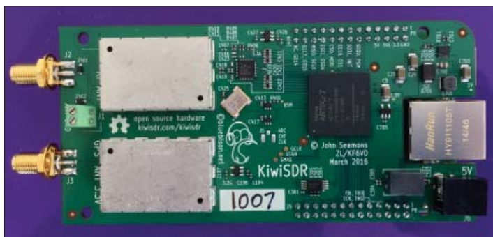
Bild 3 – KiwiSDR från Nya Zeeland är en "plug and play"-lösning för att kunna ansluta en högpresterande mottagare till nätet. Ingen PC-server behövs och prestandan är mycket god. Upp till 4 simultiga användare. På bilden ser man radiokortet, det pluggas på en Beaglebone Processorkort som sköter kommunikation och en hel del av databehandlingen. Bild från konstruktören.
