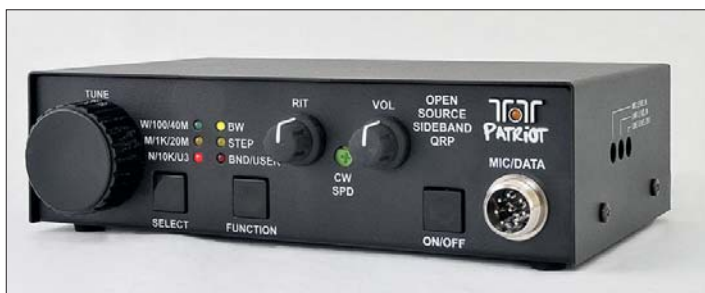
Bild 1: Så här ser en TENTEC 507 Patriot ut från framsidan. Det viktigaste finns på plats. Förutom display som man lätt kan komplettera med och som är en av dom större muntrationerna för egna experiment.
