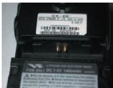
Djupt där nere sitter kontakten för att ansluta extern monofon eller kabel för programmering av riggen via PC. Batteriet är på 7.4 Volt och 1.4 Ah. Kontakterna är förgyllda och fjädrande. Allt gör ett rejält intryck.
