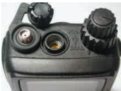
Djupt där nere sitter kontakten för att ansluta extern monofon eller kabel för programmering av riggen via PC. Batteriet är på 7.4 Volt och 1.4 Ah. Kontakterna är förgyllda och fjädrande. Allt gör ett rejält intryck.
