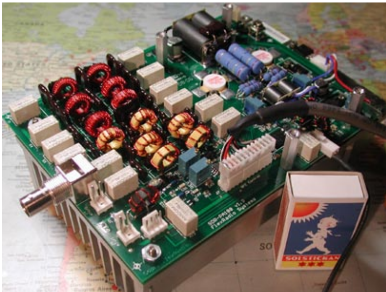
Närstudie av PA-modulen (option) på 100 friska watt. Vid BNC-kontakten för antennanslutning syns lågpassfilterna. Den automatiska antennenpassningsenheten (option) ansluts till detta kort. Kylflänsen ser ut att vara väldimensionerad.
