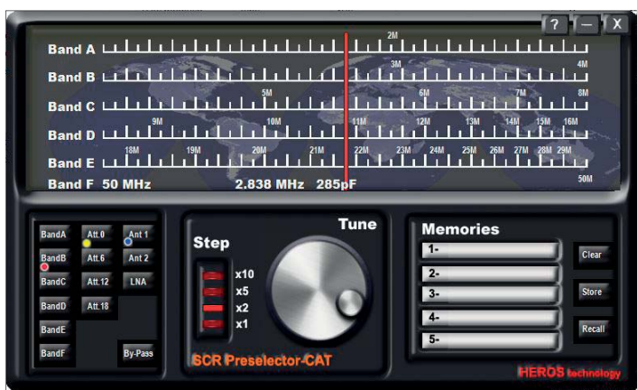
Bild 2: Kan man inte styra preselektorn från radiostyrningsprogrammet så kan man använda denna flotta programvara från leverantören. Ser ut som gamla tiders extern preselektor.
