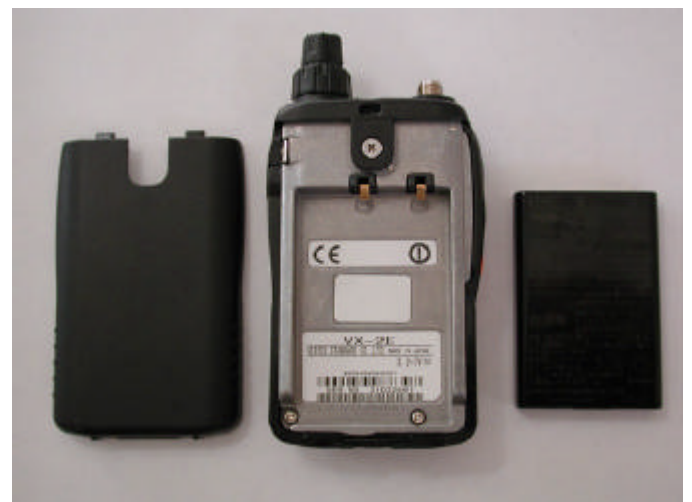
Vid öppnad lucka där bak finner man det gjutna chassiet och det lilla Li-ion-batteriet på 1000mAh och 3.7 Volt. Batteriet är bara 7 mm tjockt.
