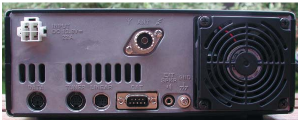
Riggens baksida med tydlig märkning av dom tillgängliga kontaktarna till omgivning. Notera den 4-poliga kontakten för spänningsmatningen och CAT-kontakten för kommunikation med en PC.
