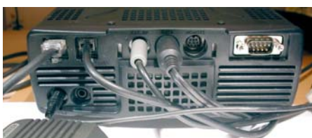
Huvudenhetens framsida är belamrad av kontakter. Från vänster till höger i ö.r – Mik, frontpanel, extra högtalare, Audio-data (ex. till ljudkort), styrning av PA, RS232 för styrning från Dator – ur. Manipulator, tgf-nyckel.
