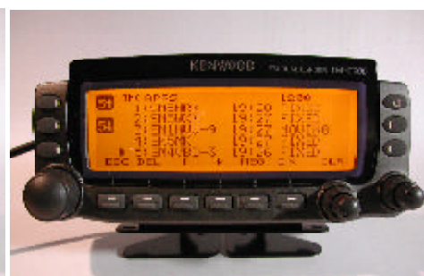
Riggen display erbjuder stora möjligheter till informationshantering beronde på applikation. Till vänster: APRS-stationsdetaljer, mitten: APRS-noder rapporterade, höger: hörda DX-clusterspottar.
