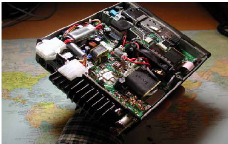
Tittar man under huven på IC-706mkIIIG finner man gott om ytmonterade komponenter och lite kabeldragning. Det borgar för låga tillverkningskostnader och hög driftsäkerhet (förutom att det bli kompakt).
