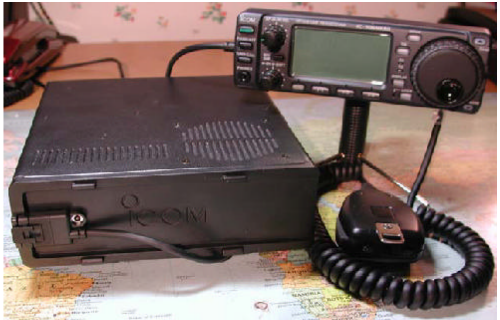
Riggens frontpanel kan lätt demonteras och via en förlängningsssladd av 3.5 eller 5 meter placeras på lämplig plats. Här har jag monterat den på ett litet bordskamerastativ med hjälp av monteringsplåten MB-63 som har bland annat en stativgänga.
