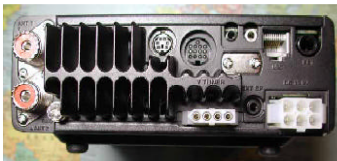
Baksidan på IC-706mkIIIG är prydlig utan löst hängande sladdar. Gott om kontakter finns det där tyvärr PL-kontaktarna sticker i ögat för anslutning av t.o.m antenn för 70cm.... Inte roligt !
