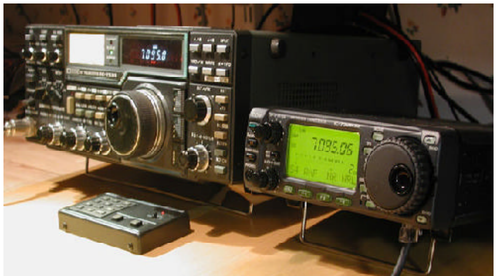
IC-706 är en mycket intressant representant för en mycket kompakt rigg som trots sin litenhet har ett mycket fint avändargränssnitt genom sin stora display. Vid jämförelse med 80-talets stjärna IC-751A ser man att mjukvaruinställningar är alternativ till alla rattar.
