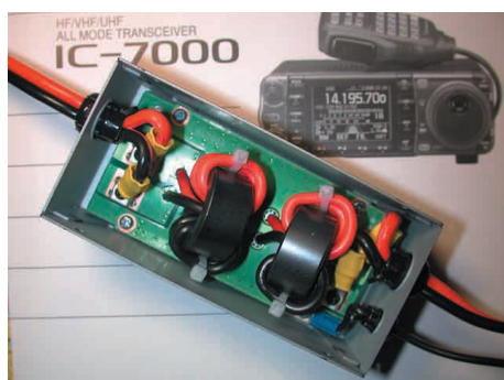
En "soap on the rope" med mätten 12x5x5 sitter på DC-sladden och levereras med Europaversionen av IC-7000. Inte elegant men nödvändigt
