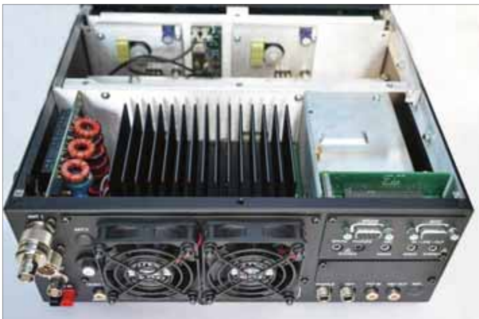
Under locket på denna rigg ser man tillägsmodulerna: Autotuner, 100 W PA och extra mottagare. Det finns även plats till ytterligare moduler som exempelvis 2m transverter.
