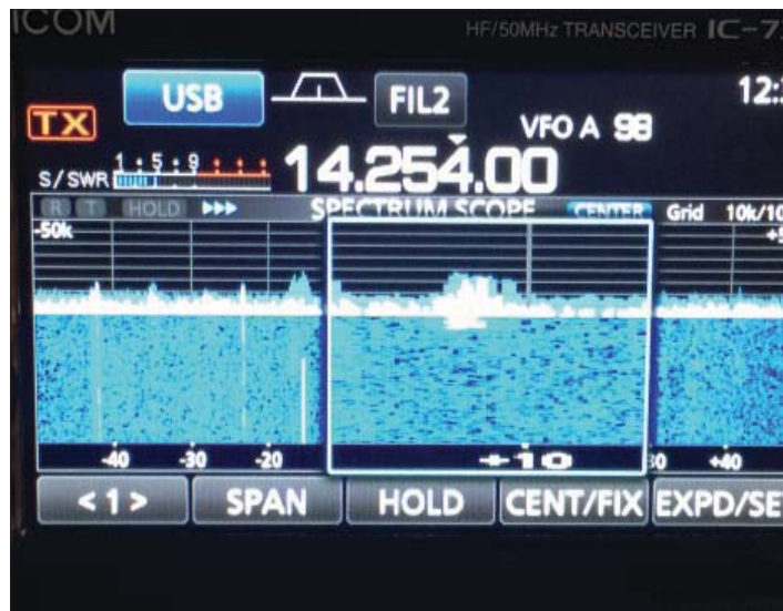
Bild 6: Radion:s display är kanske inte stor med sina 11 cm på diagonalen. Tydligt och lättläst är det dock. Inte bara i färg utan även tryckkänslig så att man likt en mobiltelefon kan navigera med fingrarna. Vattenfallet kan anpassas i storlek och omfång beroende vad man vill se. Här har ett utsnitt visats för att visa hur man kan ”zooma” in på stationen att lyssna på.
