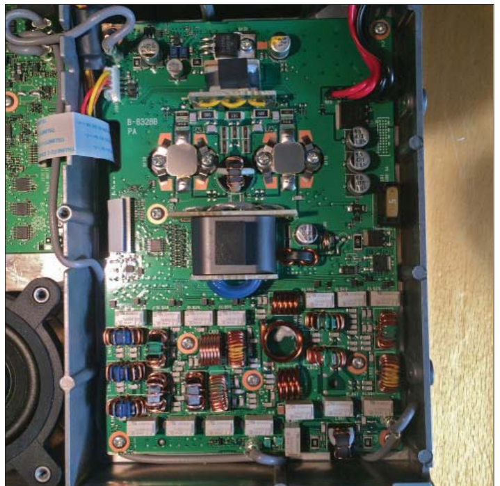
Bild 4: Sändarens förstärkardel ser ut som i vilken radio som helst. Här ser man även lågpasfiltrena i nedre delen på bilden. Snyggt och prydligt är det onekligen.
