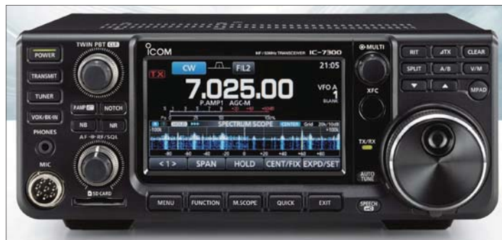
Bild 1: Frontpanelen på IC-7300 ser nästan ut som vilken modern ICOM-radio som helst. Skillnaden med denna radio är att det är en "riktig" SDRadio som ger mycket goda prestanda till ett toppenpris.
