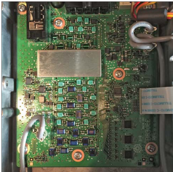
Bild 3: Gott om ytmonterat är vi vana vid. Även en SDRadio behöver en hel del komponenter. Här är det mottagaringångens bandpassfilter.
