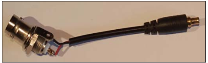
2: MCX-kontakten till dom enkla DVB-T-stickorna är väl så där lagom imponerande, en enkel ”adapter” på bilden där en BNC-chassiekontakt lösts fast på den kortade antennkabeln. Inte snyggt, men på detta sätt kan man ansluta sig till riktiga antenner.
