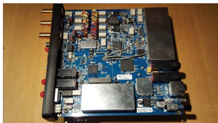
Bild 2: Under locket finner man ett kretskort fullt med ytmonterade komponenter. Radion är utvecklad i Ryssland men ser ut att vara mycket välgjord i Taiwan. Dom tre förgyllda kontakterna uppe till vänster i bild är av den mycket udda typen mini-UHF.
