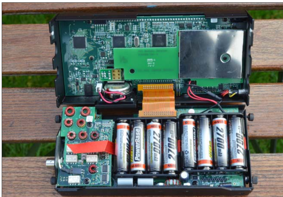
Det är lätt att öppna riggen med dom 4 skruvarna. Batterierna i sin batterihållare dominerar bilden på den analoga sidan. Till vänster om batterierna sitter tillbehörsautomatanpassaren. Den övre delen i bild innehåller digitaldelen med mikroprocessorer och DSP. Var rädd om bandkabeln i mitten på bilden.
