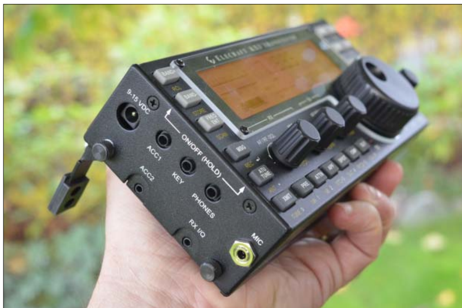
På kortsidorna sitter kontakterna för anslutning till omvärlden. Alla kontakter är jack med 2.5 eller 3.5 mm diameter. Kanske inte det mest robusta för fältbruk men platsbristen påkallar denna lösning. I bakkant ses ett av benen som kan fällas ut för att få en bra arbetsvinkel.
