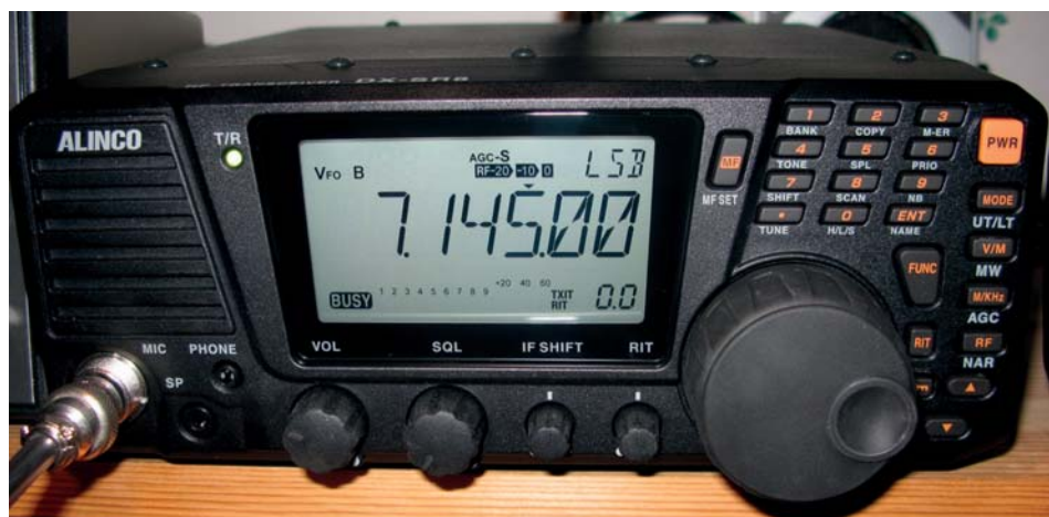
Rejäla knappar och display på riggens front som mäter 9 x 14 cm. Fronten kan demonteras för delning mot huvudenheten som kan stuvas undan.
