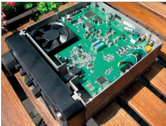
Den stora fläkten kylar termostatstyrt riggen. Kretskortet innehåller mottagare och sändarkedjan. Gott om plats då lådan är förhållandevis stor. Mikroprocessorn till huvudkortet syns nere i bild. Snett upp till vänster därifrån syns kontakten som ansluter kabel som går till frontpanelen.
