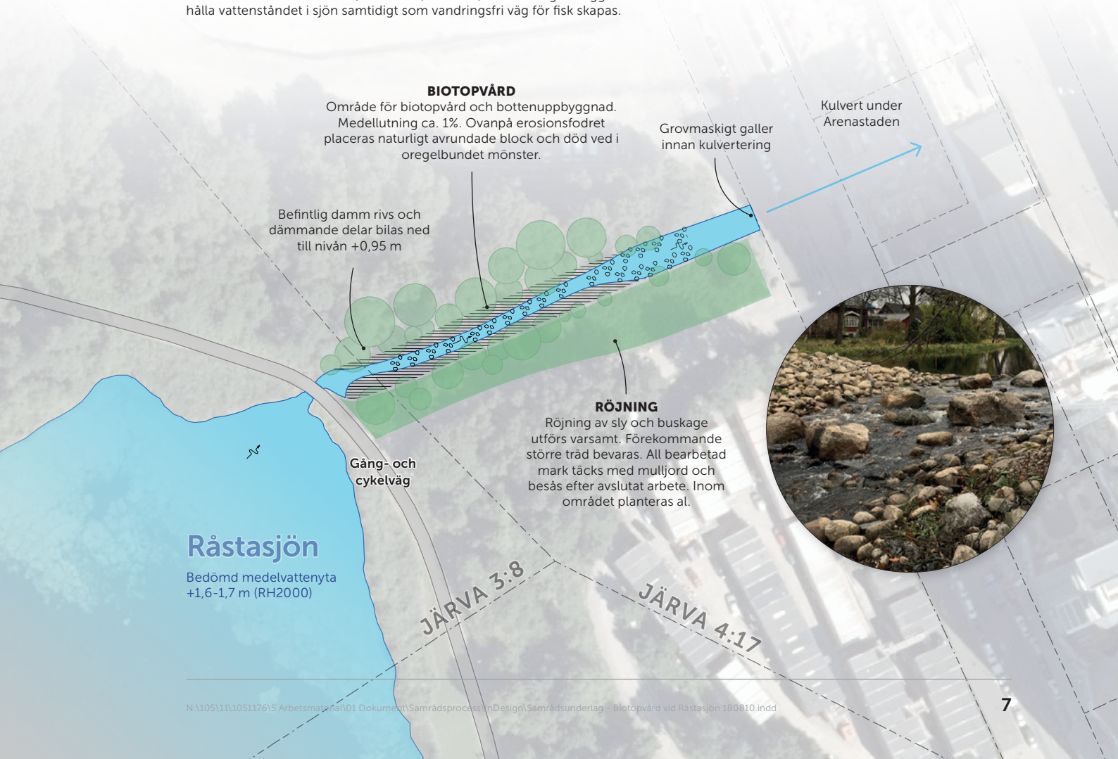
FIGUR 4. Planerade åtgärder innebär bland annat att dammen rivs och ersätts av en naturliknande tröskel (infälld bild) där sten, block och grus läggs ut för att hålla vattenståndet i sjön samtidigt som vandringsfri väg för fisk skapas.
