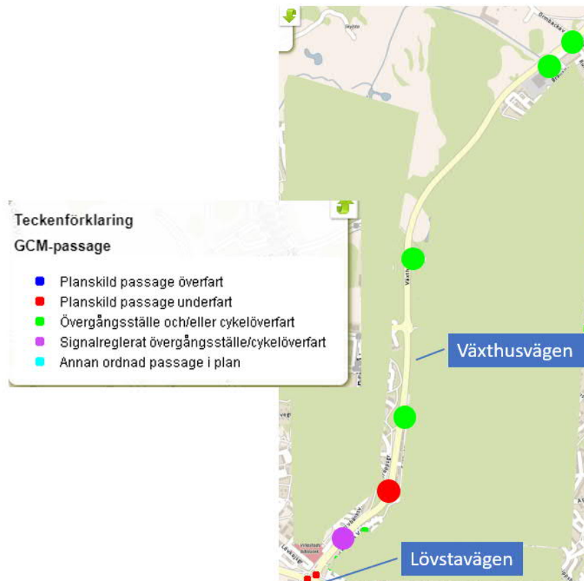
Figur 8: Punkter där oskyddade trafikanter korsar Lövstavägen. Övergångställen är upphöjda vilket innebär att oskyddade trafikanter får korsa där trafiken går långsammare. (Källa: NVDB)
