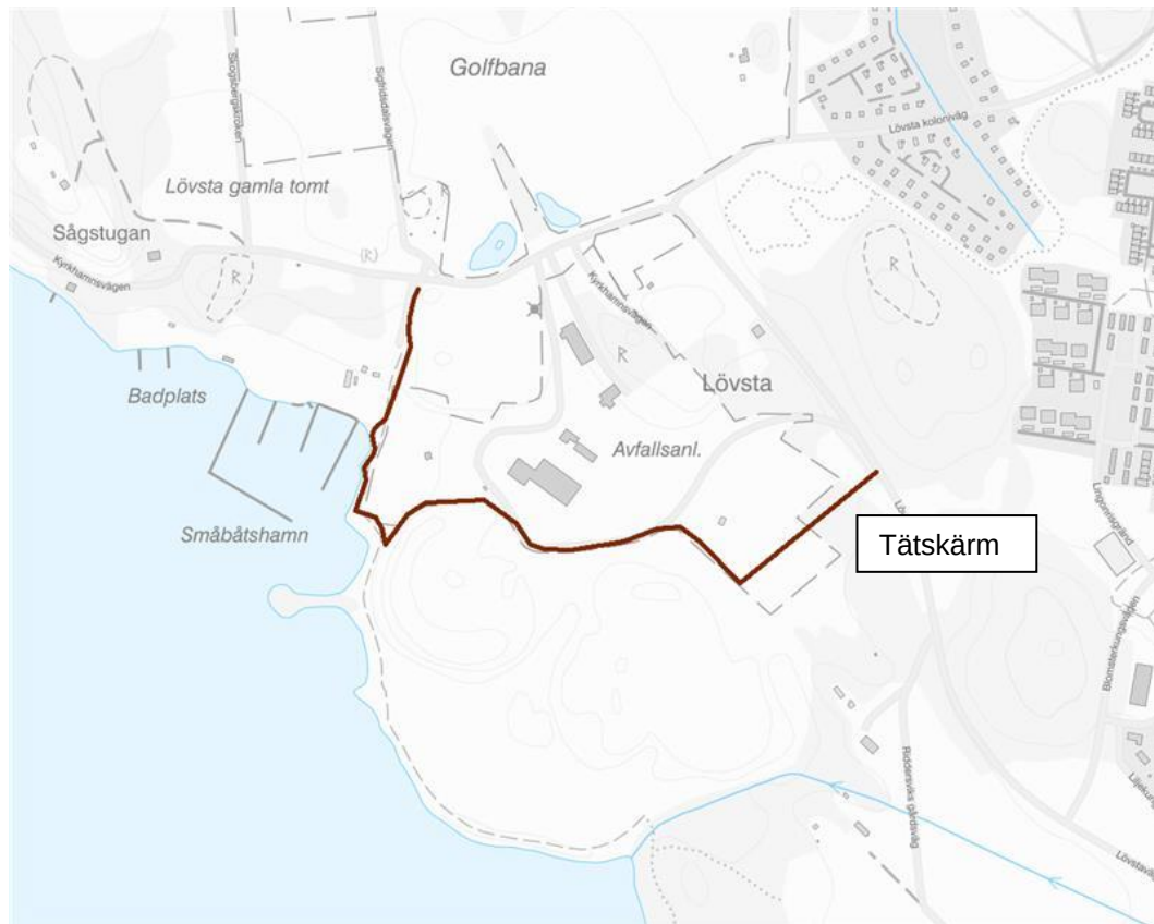
Figur 4-3: Placering av tätskärm
