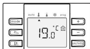
Remarque : sans action sur les touches, le retour au mode actif se fera automatiquement au bout de quelques secondes.
