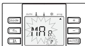
Pour sortir du mode programmation, appuyez sur **[mode]**, l'appareil revient automatiquement au mode Auto-confort.
