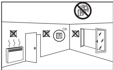
**Important :** Afin de garantir le bon fonctionnement du produit, s'assurer que le thermostat d'ambiance n'est pas installé à proximité d'une zone pouvant être perturbée par un émetteur parasite.
