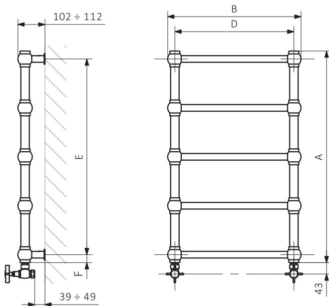
A – hauteur B – largeur C1-C5 – écartement des raccordements D – écartement des consoles en horizontal
