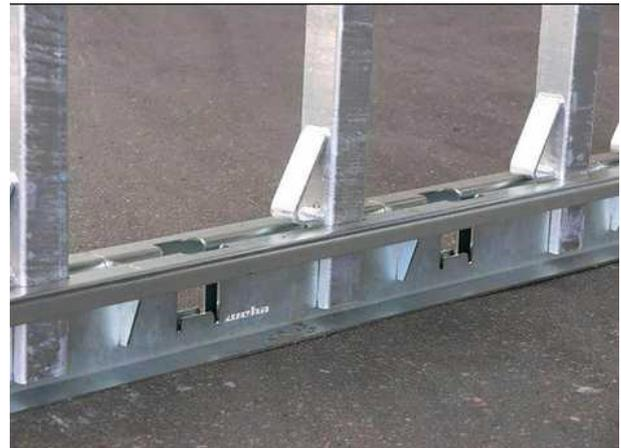
Detalle del acoplamiento entre Riel y Mastil
