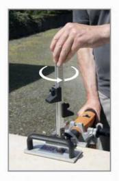
La regla puede girar 360 ° sobre si misma para un rápido y preciso cambio de posición para reflejar los agujeros de perforación con esquina diferente en distancias en lados opuestos de la losa.
