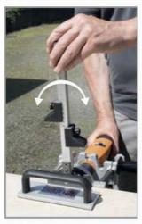
Las reglas son pivotables 180 ° para realizar un cambio rápido y preciso de posición desde la i zquierda a la derecha..
