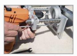
Ajuste básico 1 Profundidad del taladro ajustable: Sujeción de tope de profundidad con tornillo moleteado. (profundidad de perforación = 100 mm).
