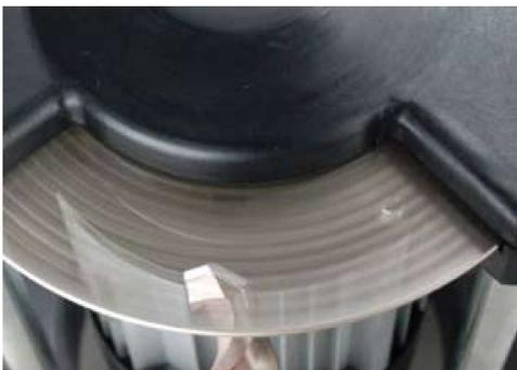
**El disco perforado, permite la vista estroboscopica
