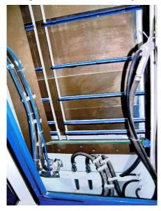
El filtro esta integrado en la parte trasera de la cabina. Se compone de dos cartuchos filtrantes, con una gran superficie de filtrado, el sistema tiene una auto-limpieza por aire comprimido. Bajo el filtro hay una tolva de recogida del polvo para poder ser vaciada fácilmente. Debido a la suficiente capacidad del aspirador mantiene el vacío aun con entrada de aire abiertas.
