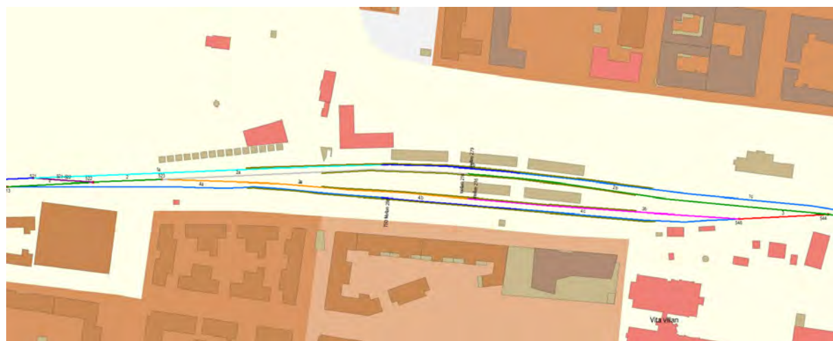
Figur 7 Växjö C spårutformning, spårnummer och plattformar (inklusive plattformshöjd "mellanhög"). Källa: Baninformationssystemet.
