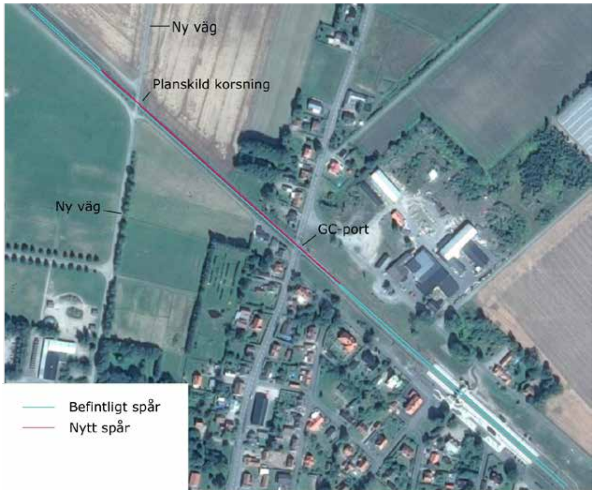
Figur 13 Partiellt dubbelspår genom sammanbyggnad av två mötesstationer vid Önnestad
