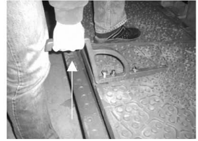
Sving lokket opp, påse at sikringsarmen faller i låst posisjon
