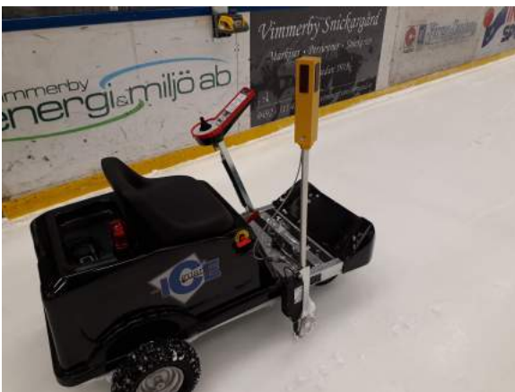
Isfräs ICEguard Robot, åkbar/självgående. 2,5 h drifttid
