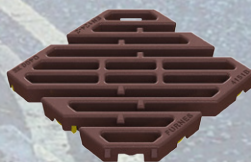
Rist 4151B passer i alle dim. Gj. strømningsareal 650 cm 2
