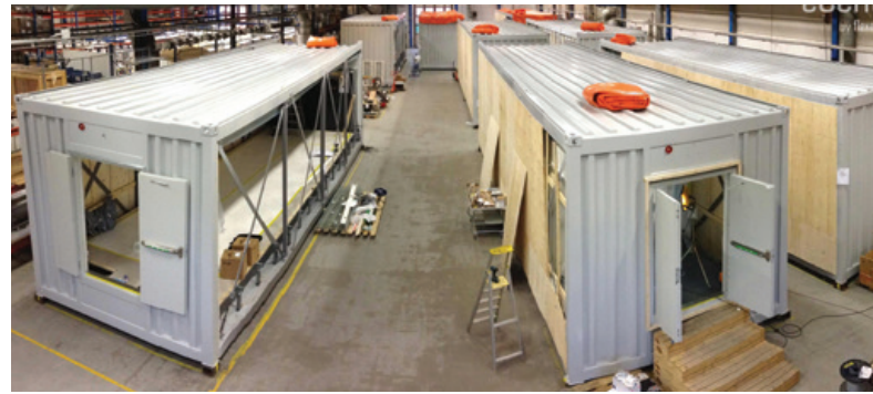
Produktion i Vara i Västergötland av eCentre, en världsledande produkt på den snabbväxande marknaden för prefabricerade modulära datacenter, hos Flexenclosure, ett av bolagen i Pegrococ Tillväxtportfölj.
