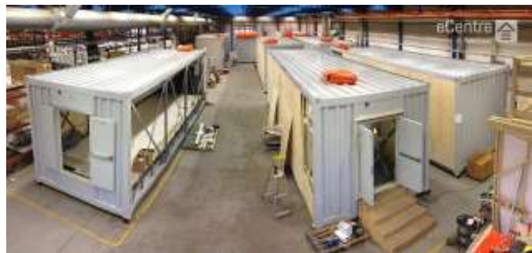
Produktion i Vara av eCentre, tillväxtbolaget Flexenclosures världsledande produkt inom det snabbväxande segmentet prefabricerade datacenter.
