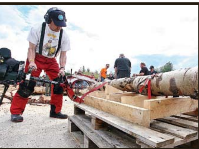
Matti Kivistö visar upp sin Sally från 1946 , en ringsåg med 4-takts cumminsmotor på 1,5 hk. Modellen har en rund sågklinga som drivs via ett drev från motorn. Ett stödben gör sågen lätt att hantera på vedbacken. Sågen tillverkades bara under en kort period i USA.
