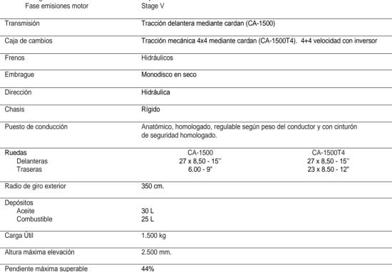
Luz rotativa. Cinturón de seguridad. Arranque y parada eléctricos. Retrovisor izquierdo. Avisador acústico de marcha atrás. Protector de carga.
