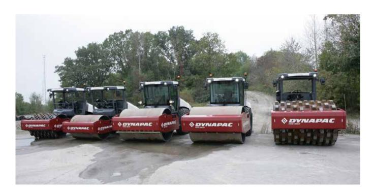
Herramientas: Un rodillo de tierras CA de quinta generación de Dynapac equipado con optimizador de compactación, medidor de compactación y analizador de compactación con GPS (opcional).
