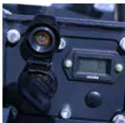
Arranque eléctrico y contador de horas que facilitan todo el trabajo
