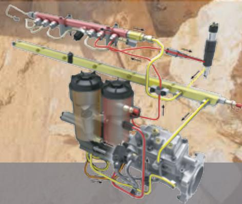
**Inyección de combustible common-rail XPI:** el suministro de combustible y la presión de inyección pueden ajustarse con independencia del régimen del motor. El sistema se adapta constantemente a las distintas velocidades para que obtenga el máximo rendimiento de cada gota de gasóleo.
