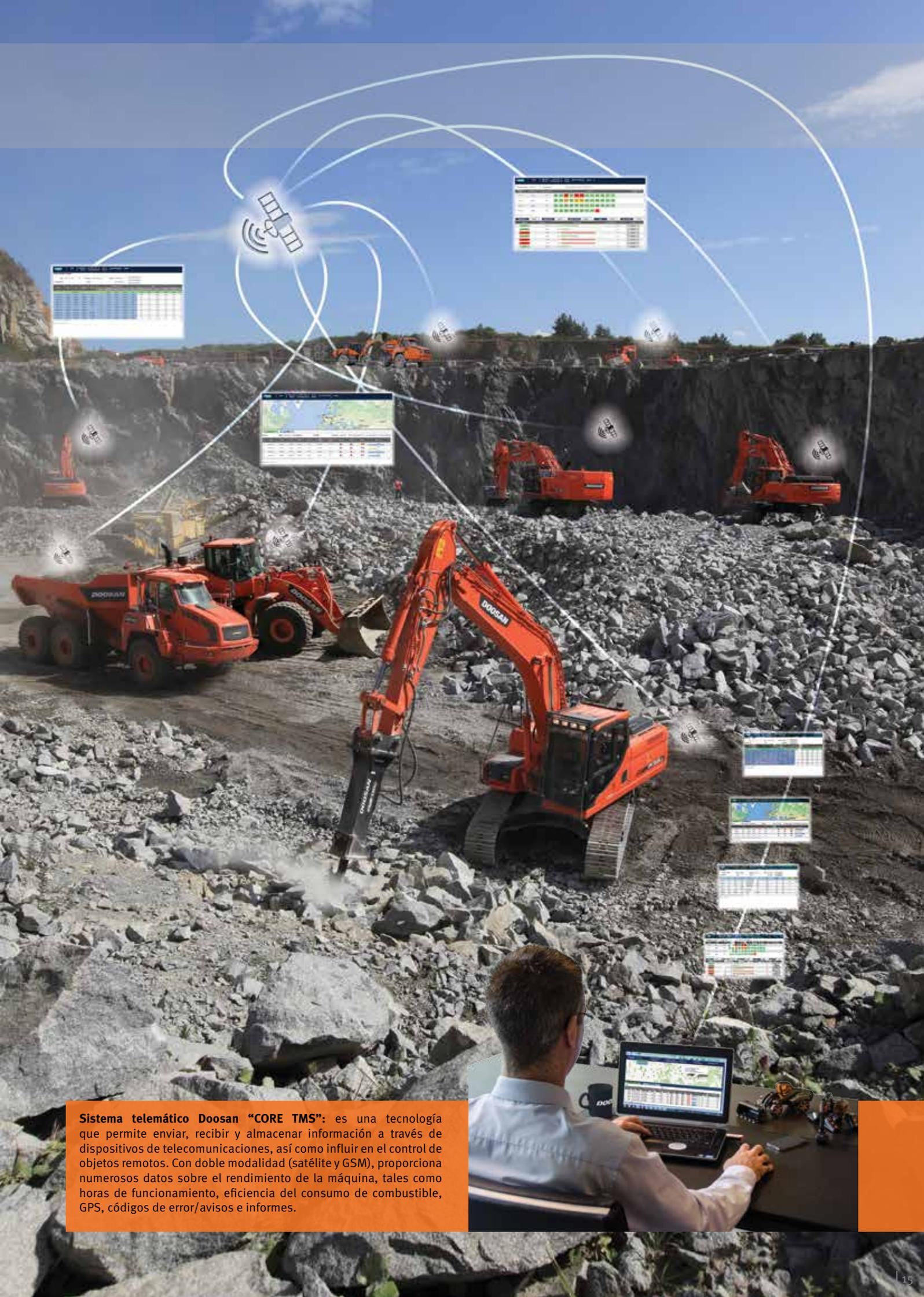
**Sistema telemático Doosan "CORE TMS":** es una tecnología que permite enviar, recibir y almacenar información a través de dispositivos de telecomunicaciones, así como influir en el control de objetos remotos. Con doble modalidad (satélite y GSM), proporciona numerosos datos sobre el rendimiento de la máquina, tales como horas de funcionamiento, eficiencia del consumo de combustible, GPS, códigos de error/avisos e informes.
