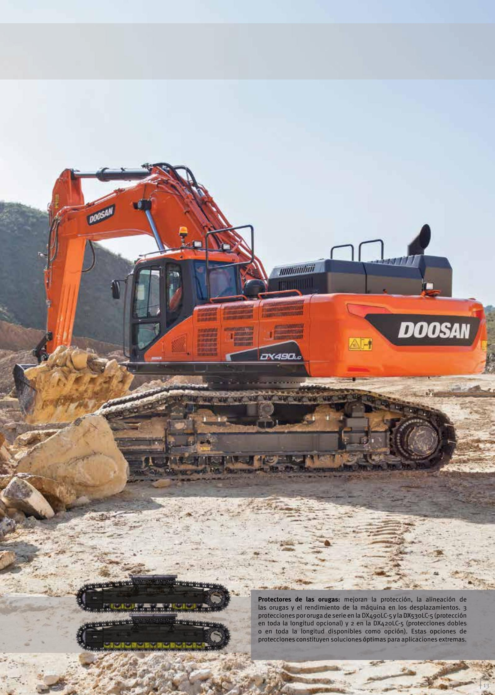
**Protectores de las orugas:** mejoran la protección, la alineación de las orugas y el rendimiento de la máquina en los desplazamientos. 3 protecciones por oruga de serie en la DX490LC-5 y la DX530LC-5 (protección en toda la longitud opcional) y 2 en la DX420LC-5 (protecciones dobles o en toda la longitud disponibles como opción). Estas opciones de protecciones constituyen soluciones óptimas para aplicaciones extremas.
