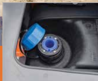
Depósito de reducción catalítica selectiva (SCR)
