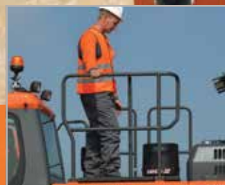
Barandillas de seguridad
