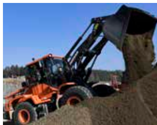
Cinemática paralela (portaherramientas)
