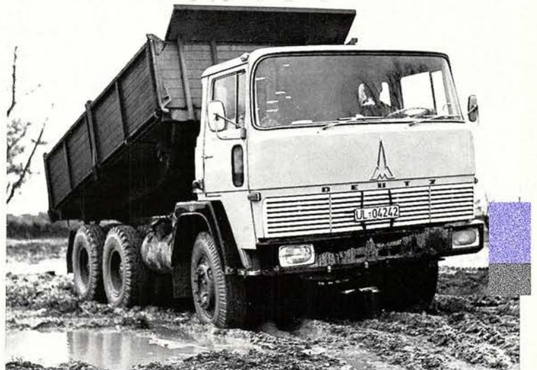
Kippersuche im Gelände zeigten, daß das Fahrzeug eine hohe Standfestigkeit hat und die Kippbrücke auch bei Verwindungen der Vorderachse von 10°, der Hinterachse von 10° 30' und des Rahmens von 11° noch in die Klauen zurückgeht. Die Federn kommen bei dieser Belastung gerade noch zum Anliegen, d. h. zum Abheben.
