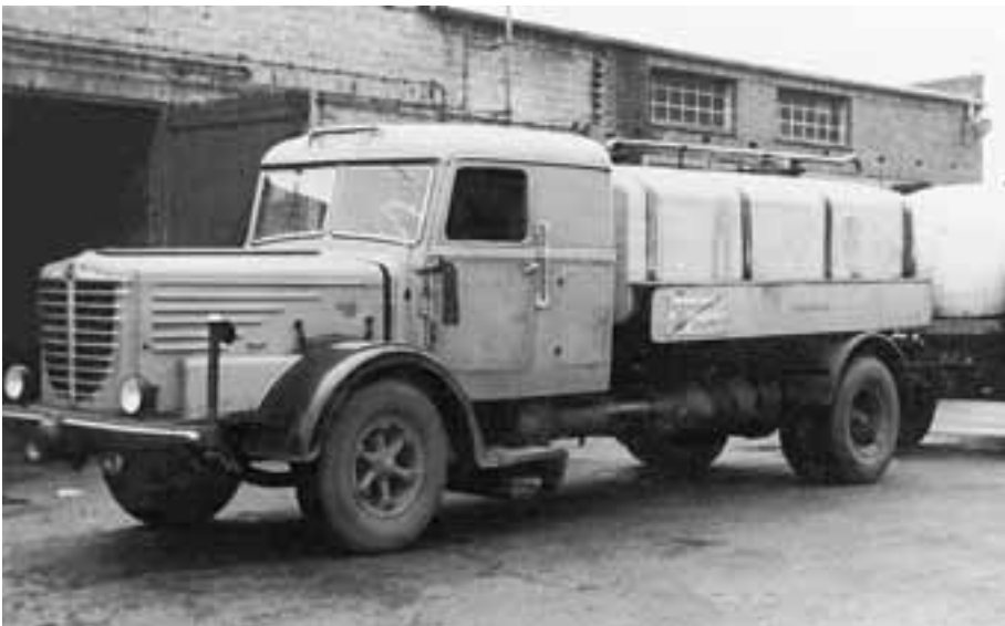
Eine Fiege-Erfindung – saisonale Nutzung durch leicht abnehmbaren Tankaufbau
