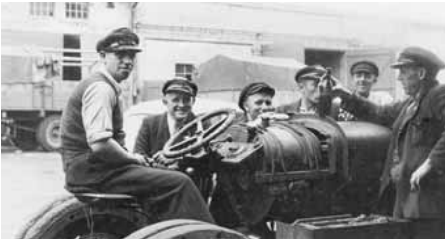
Der Rangiertrecker, Typ Hanomag, Baujahr 1936, mit Vollgummibereifung
