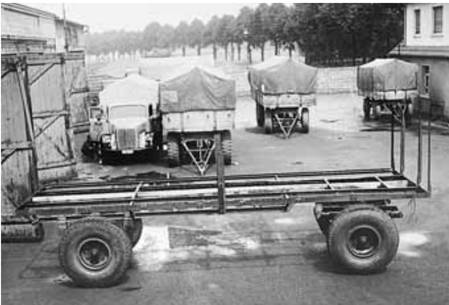
Eigenbau – Anhängerfahrgestelle in Leichtbauweise
