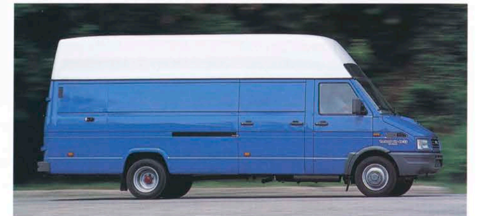
Der Großvolumen-Kastenwagen: Innenhöhe 2100 mm, Radstand 3950 mm, Ladekapazität 17 m 3 .
