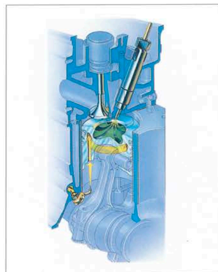
Detail der Direkteinspritzung mit neuer Fünflochdüse und gekühlter Ventileführung.
