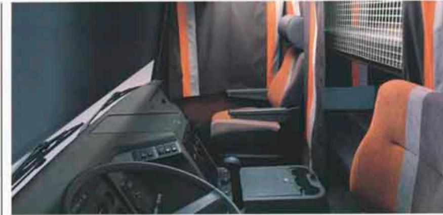
Innenkabine komfortabel und zweckmäßig: geschwungene Instrumententafel, verstellbares Lenkrad, luftgefederter Fahrersitz, hydraulisch gefederter Beifahrersitz, zahlreiche Ablageflächen und -fächer.
