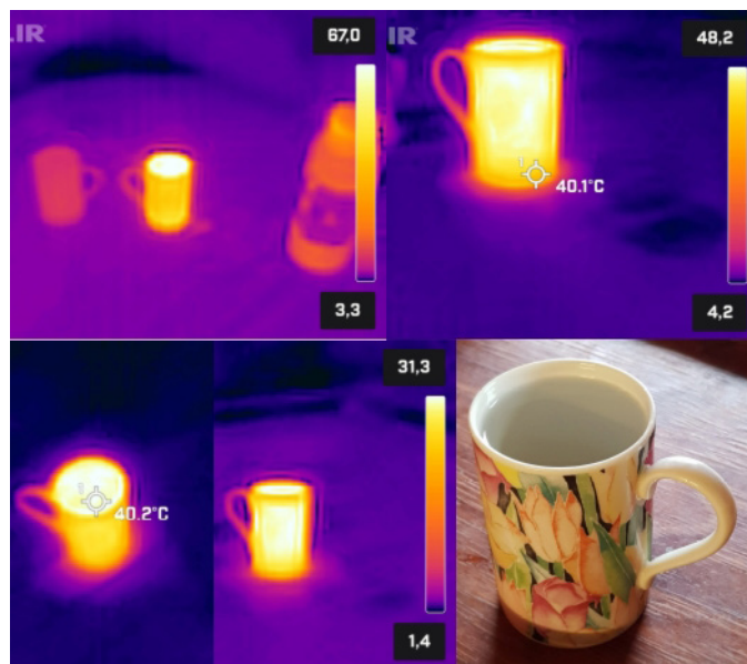
Bild 3. Några IR-bilder av en mugg med kranvatten och en med kokhett vatten. Efter 50 minuter har vattenytan sjunkit ungefär 1 cm i muggen med det varma vattnet, men nästan inte alls i den andra muggen.
