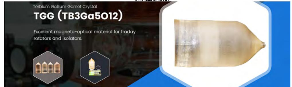
Le Terbium Gallium Grenat (TGG) est une sorte de grenat synthétique. Ce cristal est magnéto-optique, avec un niveau élevé de conductivité thermique pour les rotateurs et les isolateurs de Faraday (de l'ordre de 400nm-1100nm, à l'exclusion de 475-500nm).
