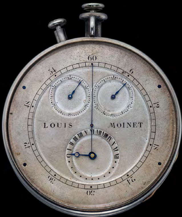
1816 — Le premier chronographe jamais réalisé, appelé également « Compteur de Tierces » par son auteur Louis Moinet.
