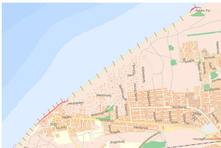
Figur 2.4 Oversigt over høfder (orange), skråningsbeskyttelse (pink) og strandfodring (lilla) ved Gammel Skagen (Kystdirektoratets Kystatlas, 2022).
