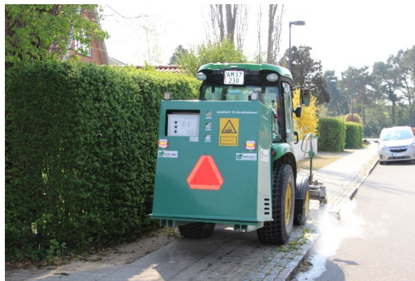
Dampning af fortov
