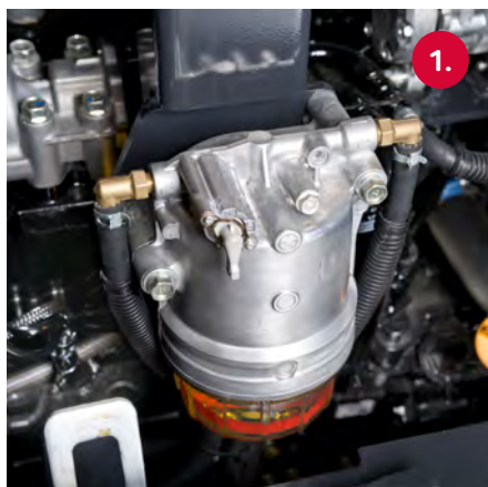
1. Bränslefilter med vattenavskiljare 4. Batteri
